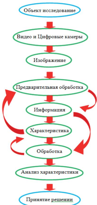
Рис. 5. Схема 2. Алгоритм обработки изображений с целью выделения текстовой информации
